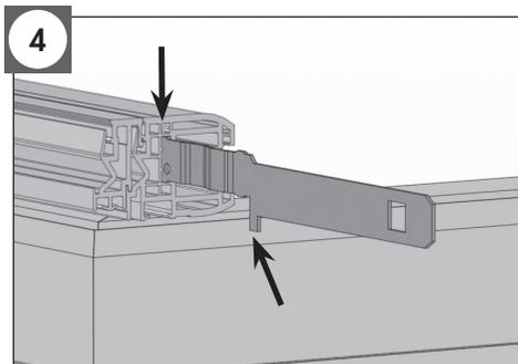
Mettre les pattes de centrage : trou de perçage à l'intérieur, ergot côté dormant.
