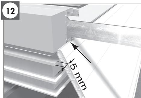
Présenter la sous-face contre l'ergot des pattes de centrage. Centrer la sous-face sur le dormant (5 mm de chaque côté pour alignement du caisson avec le dormant).
