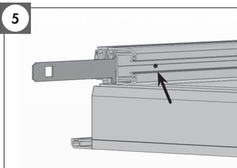
Fixer la patte de centrage à la coulisse PVC avec la vis TCB 4x10 livré dans le colis d'accessoires. Pour la coulisse Alu AF, fixer avec une vis autoforeuse TCB 3,9x10 non fournie.
