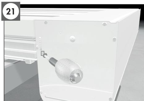
Fixer le caisson sur la menuiserie. Vis recommandées : TC diamètre 4, longueur selon menuiserie.
