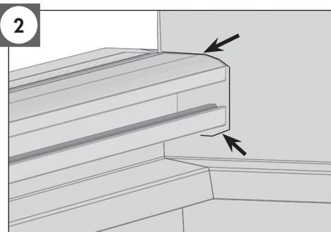
Étancher la pièce d'appui avec une plaquette silicone (non fournie).
