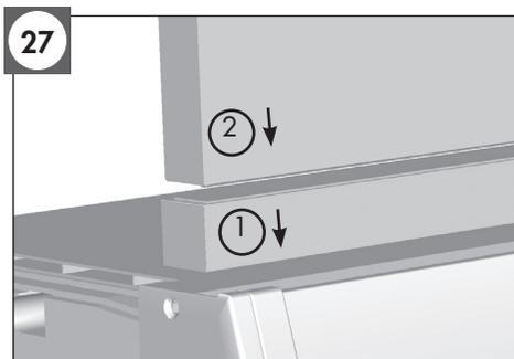
Plier la pince et glisser les plats à l'intérieur, ajustement possible de 20 à 70 mm.
