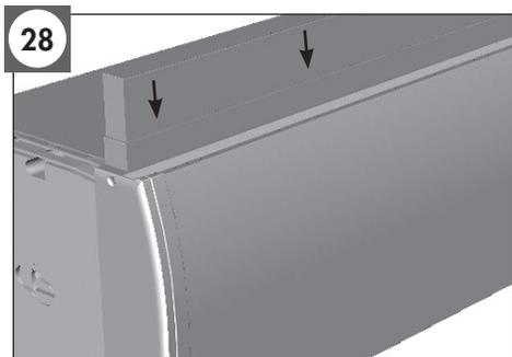
Coller la pince sur le caisson, ajuster les plats au plafond si besoin.
