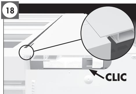
Engager la lame finale dans les coulisses en veillant au verrouillage des pattes dans les joues et au recouvrement du caisson.
