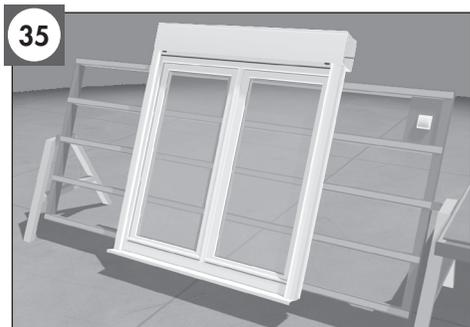
Redresser le poste de travail et faire un test de fonctionnement descente - montée.
