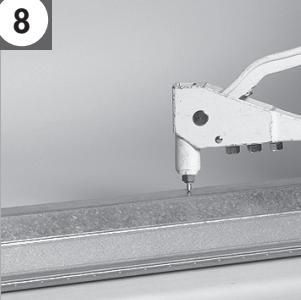
Riveter le nouveau moteur avec 2 rivets 4x8 (fournis)
