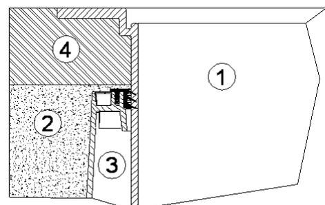
**Attention :** Il faut absolument utiliser une rehausse télescopique en fonte (avec couvercle en fonte de classe B).
