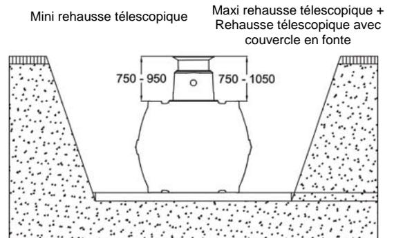
Hauteurs de recouvrement maximales avec pièces intermédiaires et cheminée-dôme télescopique.
