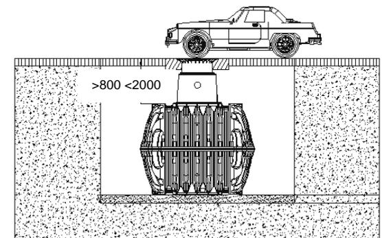
Hauteurs de recouvrement avec rehausse télescopique passage camions ou en fonte (avec couvercle de classe D – non fournis) dans la partie soumise à des charges de poids lourds (charge max. 12 t).
