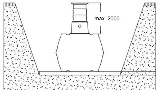
Hauteurs de recouvrement avec rehausse télescopique en fonte (avec couvercle en fonte de classe B) dans une zone soumise aux charges de voitures (charge max. 3,5 t).
