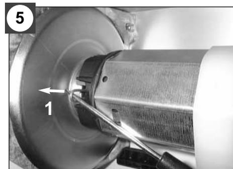
Libérez l'axe côté moteur : tirez l'anneau de verrouillage du connecteur (1) et tirez l'axe (2).
