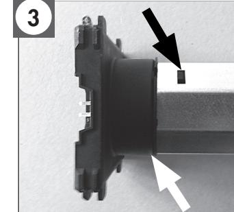
Déclipper les 2 ergots pour retirer le moteur
