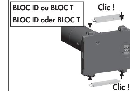
Clipper les réglettes Verbindungsstücke am Adapter anbringen
