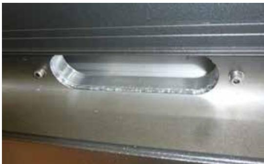
3. À côté des trous trop-pleins en forme d'haricot vissez des deux extrémités les vis M5x20 à tête cylindrique inoxydables allens avec une rondelle (fig. 18)
