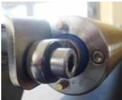
**ATTENTION:** Le réglage des courses doit être effectué uniquement manuellement avec une clé. **L'utilisation du tournevis/perce peut endommager les crémaillères des courses.** Pratiquement, le réglage peut être effectué seulement sur le bouton « max » (fig. 33)
