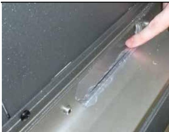
4. Dans tous les trous latéraux ovales de trop-plein et de dérivation des gouttières, sécurisez avec le silicone un bord inférieur et les bords circulaires latéraux de liaison des gouttières de barre avec les trop-pleins. (fig. 19)
