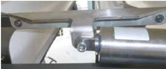
5. Installez la première et la dernière lame et les deux lames du milieu pour déterminer le lieu d'installation du moteur et la position correcte pour son assemblage. Le piston du moteur doit être rétracté et les lames de la pergola doivent être en position ouverte. Après avoir installé le moteur (paragraphe 4.6.1.4), vérifiez que les lames se ferment facilement lorsque le piston est sorti.
