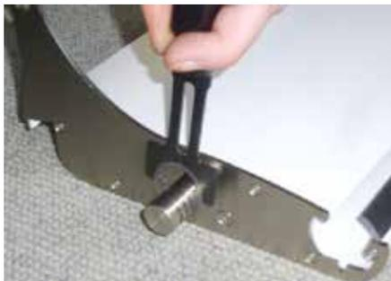
1. Aux boulons du côté d'encastrement mettez les grandes bagues de retenue dans la deuxième rainure de la surface de bouchon – répétez l'opération pour toutes les lames de même côté et dans la même rainure. (fig. 21)
