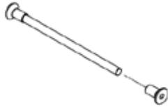
14. Les écrous à larder et les épingles filetées (fig. 11) sont destinés pour la liaison des modules des pergolas SB400. Dans les barres et les poteaux des trous coaxiaux sont effectués avec l'approfondissement.
