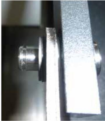
5. Installez le brin d'entraînement successivement aux autres lames. Appliquez par la rotation un trou d'embout d'entraînement d'une lame à un trou dans le brin. Appuyez le boulon du support du côté de la lame dans une liaison (sens inverse est aussi autorisé) jusqu'à l'apparition de la deuxième rainure d'installation (plus loin de la fin). Mettez la petite bague de retenue (fig. 28).
