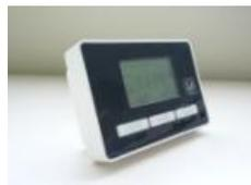
Le module de télécommande communique en permanence avec la centrale IDEO. La durée de vie des piles, pour une utilisation normale (interrogation par l'utilisateur 5 fois par jour en moyenne) est estimée à environ 3 ans. Le niveau de pile est visualisable directement sur l'écran (Repère 10). Le module est équipé de deux piles type AA – 1,5V –LR6.
