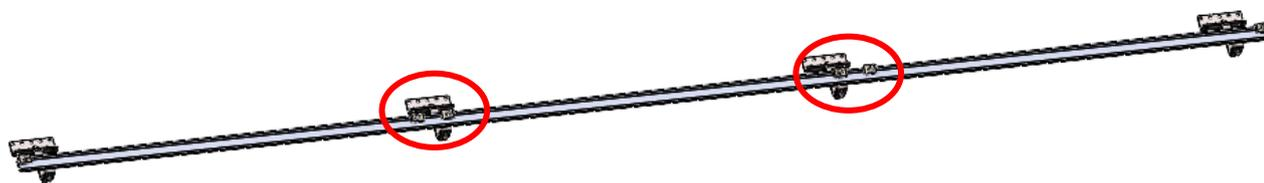
Veillez à ce que les clames de fixation intermédiaires se retrouvent entre les capteurs et non sous un capteur. La tête de vis pourrait perforer le fond du capteur et par conséquent nuire à son étanchéité.
