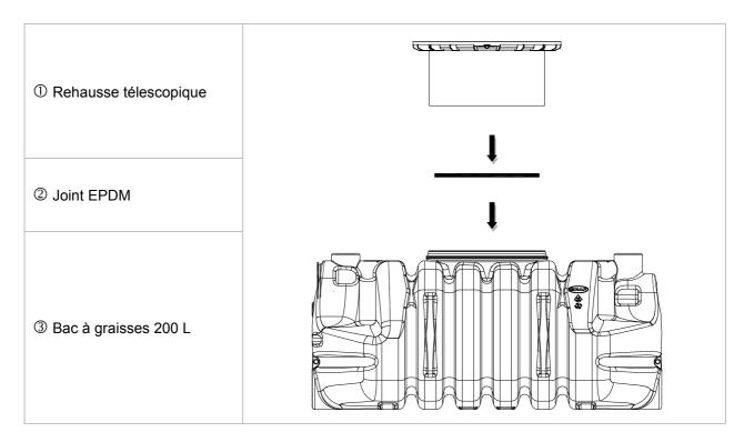
La rehausse télescopique permet un ajustement facile et réglable en hauteur. La hauteur max de recouvrement est de 190 mm.
