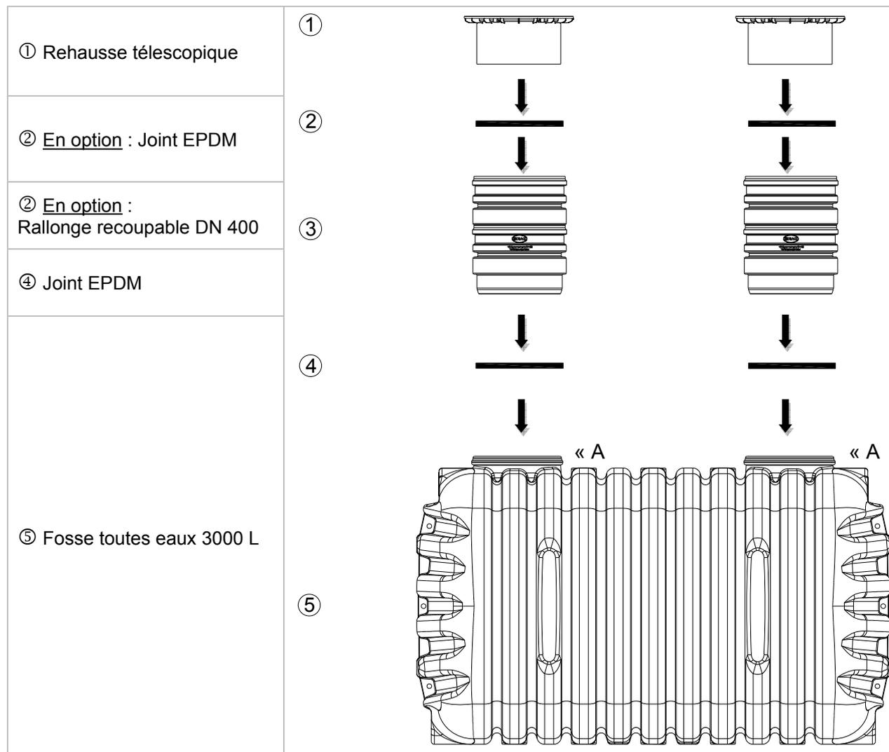
La rehausse télescopique permet un ajustement facile et précis de la cuve par rapport au niveau du sol avec un recouvrement compris entre 100 et 220 mm maxi.
