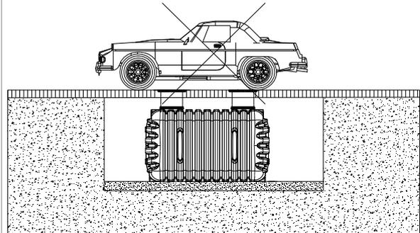
Pour une installation en nappe phréatique, l'immersion maximum ne doit pas dépasser 600mm. Il est impératif que la hauteur de recouvrement au-dessus de la cuve soit de minimum 500mm et de 600mm maximum.
