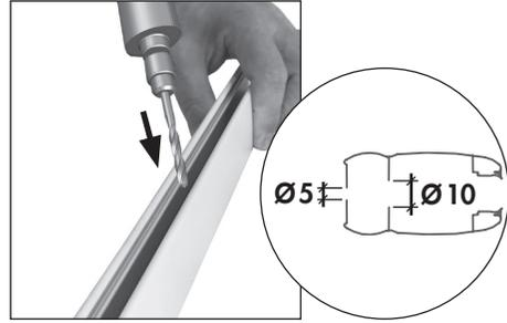
Percer uniquement la paroi intérieure des trous par l'intérieur de la coulisse à l'aide d'un foret diamètre 10 mm
