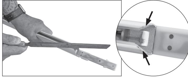
A l'aide d'une lime, réaliser les 2 biseaux en haut de la coulisse.
