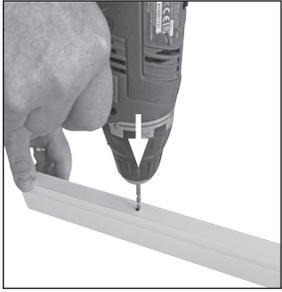
Percer les 2 parois aux positions tracées au dos de la coulisse avec un foret de 5 mm
