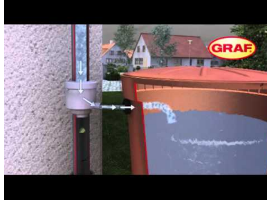
Comment fonctionne un collecteur de gouttière ?
