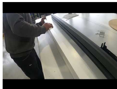
Montage du criquet sur le profil
