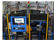
Banc automatisé de rodage de tous les moteurs, en conditions réelles d'utilisation et sous conditions dégradées en tension
