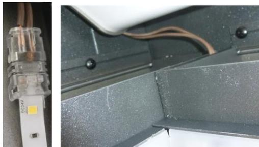
8. Placez les connecteurs de câble avec câbles intégrés aux extrémités de la bande de LED avec connexion d'alimentation. (fig.6 - gauche). Les câbles doivent être insérés dans la rainure de l'embout de gouttière - Fig. 6 à droite (version préparée pour LED) ou placés au bord de l'embout de gouttière (version sans LED). Au-dessus des gouttières du poteau, faites un trou dans un endroit pratique pour insérer les câbles dans le poteau.
